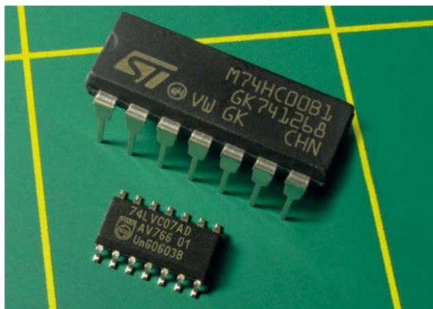
Figure 4-2. Un circuit intégré traversant (en haut) et un composant monté en surface (en bas).
