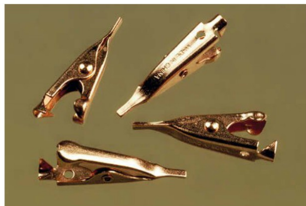
Figure 3-20. Ces petites pinces crocodiles en cuivre absorbent la chaleur afin de protéger les composants fragiles durant les opérations de soudure.
