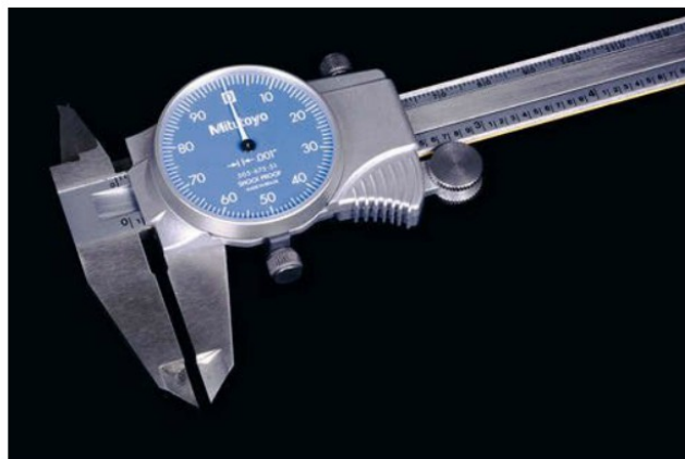
Figure 3-17. Un pied à coulisse, analogique ou numérique, peut mesurer un diamètre intérieur ou extérieur.
