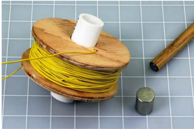
Figure 5-18. Bobinage de 200 spires de fil de câblage sur une bobine en contre-plaqué et un aimant plaqué sur une vis fixée sur une tige en bois.
