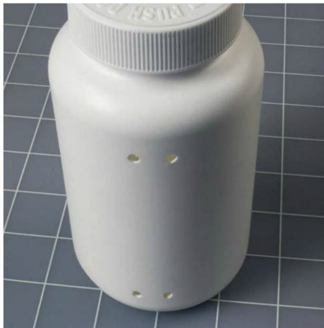
Figure 5-64. Les trous vont servir à maintenir le fil enroulé autour de la bouteille.
