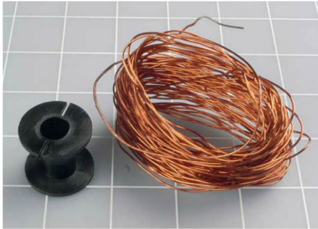
Figure 5-56. La bobine en plastique et le fil émaillé.
