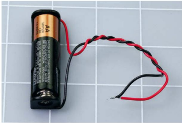
Figure 1-30. Court-circuiter une pile alcaline sera sans danger si vous suivez attentivement les instructions.
