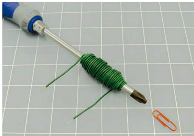
Figure 5-9. Lorsqu'il est relié à la pile, cet électroaimant simple est capable de déplacer un trombone.
