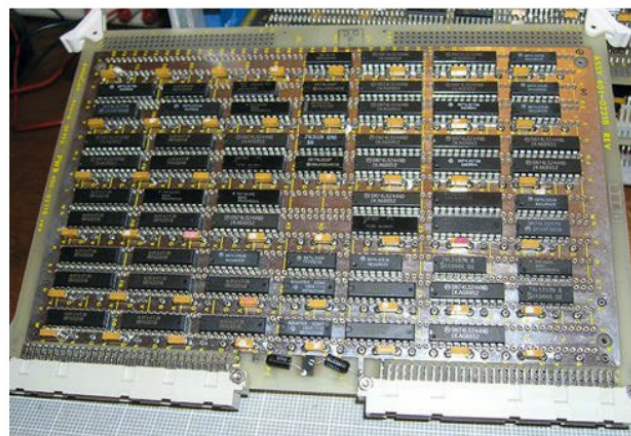
Figure 4-83. Cette carte-mère d'ordinateur, réalisée manuellement par Bill Buzbee, utilise des circuits intégrés logiques de la série 74xx et constitue la base d'un serveur web.
