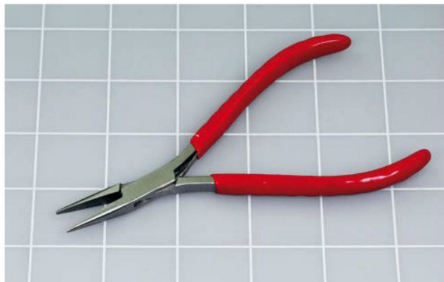
Figure 2-3. Pince à bec long permettant des travaux précis à petite échelle.
