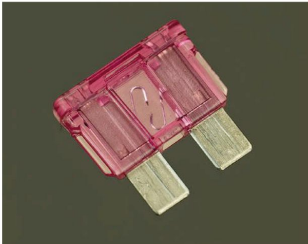
Figure 1-37. Fusible de 3 A qui a fondu sous l'effet du courant électrique.
