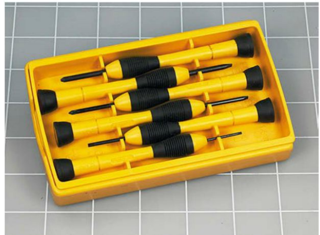
Figure 2-1. Tournevis miniatures avec bouts plats et à croisillons Philips. Les carreaux blancs mesurent 2,5 cm de côté.
