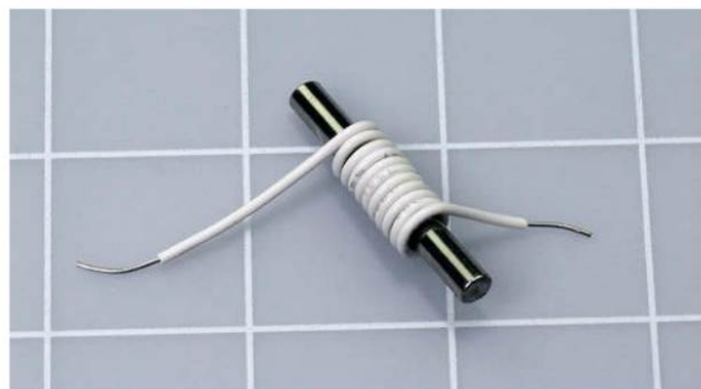
Figure 5-16. Dix spires de fil suffisent à créer un potentiel électrique quand un aimant se déplace à l'intérieur.
