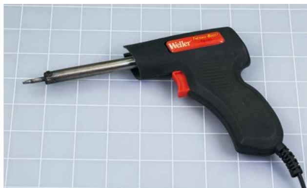
Figure 3-4. Le fer à souder Weller Thermo-Boost 30 W est pratique pour souder les fils et les composants les plus gros.
