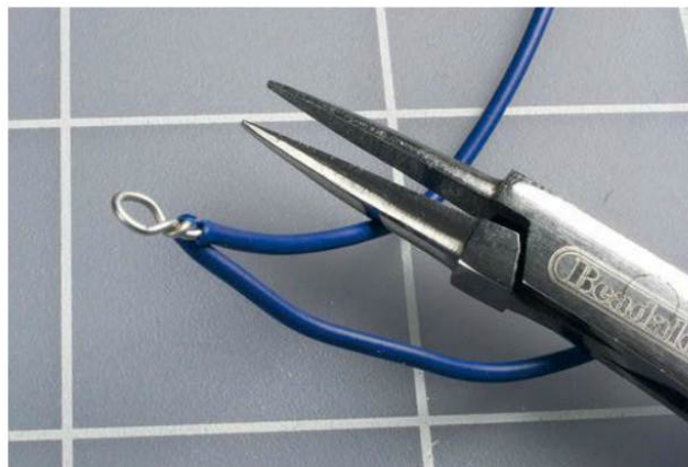
Figure 5-67. Faites une boucle avec la partie dénudée du fil.
