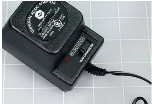
Figure 3-1. Cet adaptateur se branche sur une prise murale et offre un choix de tensions de sortie par le déplacement d'un petit commutateur.
