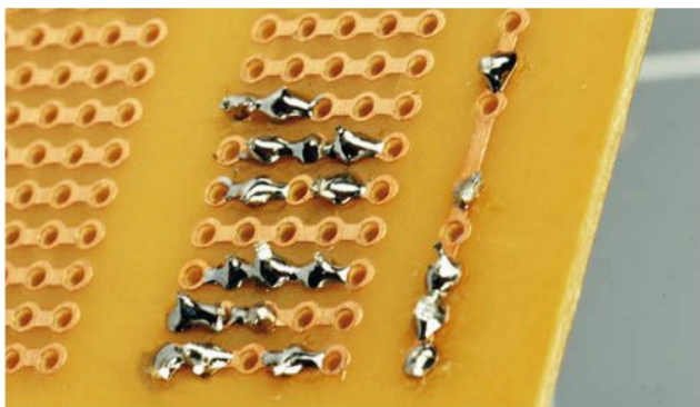
Figure 4-51. Après avoir été soudés, les fils sont coupés à ras, et les soudures sont examinées à l'aide d'une loupe. Deux ou trois autres composants peuvent maintenant être insérés et le processus se répète.
