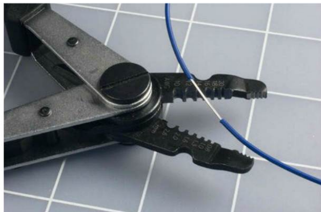
Figure 5-66. Utilisez votre pince à dénuder et vos doigts pour libérer environ 13 mm d'isolant.
