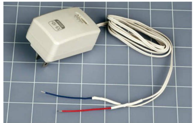
Figure 3-47. Les fils de jauge AWG 22 peuvent être insérés dans une plaque de montage, pour l'alimenter.
