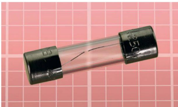
Figure 1-38. Court-circuit d'un fusible à cartouche en verre.
