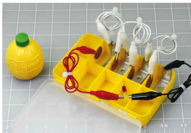
Figure 1-65. Le jus d'un citron ou le jus concentré en bouteille produira les mêmes effets, même si le montage n'est pas très beau. Ici, une boîte à plusieurs cases a été utilisée pour construire une pile au jus de citron comportant quatre cellules.
