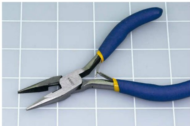
Figure 2-2. Une pince plate convenant aux travaux d'électronique ne doit pas dépasser 13 cm de long.
