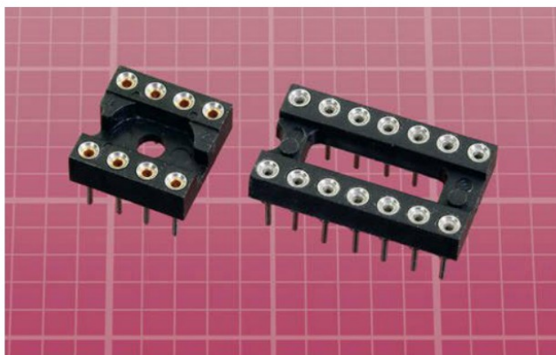
Figure 4-4. Vous pouvez insérer vos circuits intégrés dans des supports soudés sur votre plaque afin de ne pas les endommager en les dessoudant directement.
