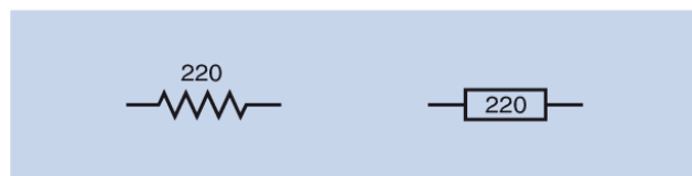
Figure 2-44. Symbole d'une résistance de 220 \Omega aux États-Unis (à gauche) et en Europe (à droite).
