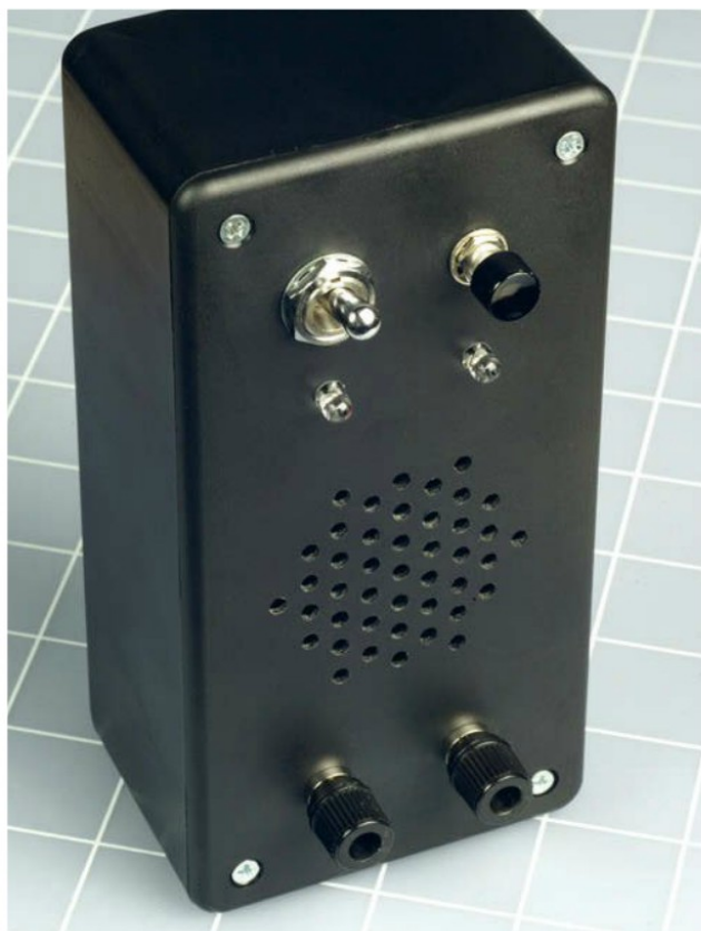
Figure 4-58. Le système d'alarme terminé.
