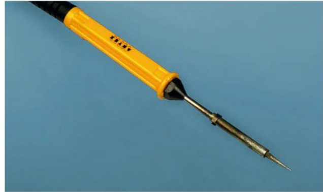
Figure 3-3. Fer à souder de 15 W adapté aux travaux électroniques délicats.
