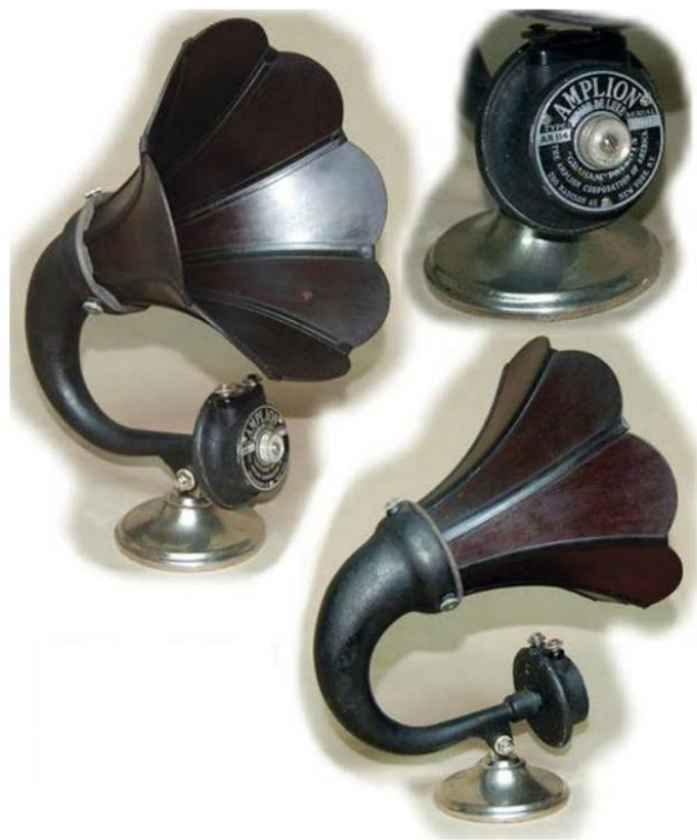
Figure 5-29. Ce magnifique haut-parleur Amplion AR-114X illustre les efforts des concepteurs pour augmenter l'efficacité, à une époque où les amplificateurs audio ne délivraient qu'une puissance limitée. Photos de « Sonny the Radiola Guy ».
