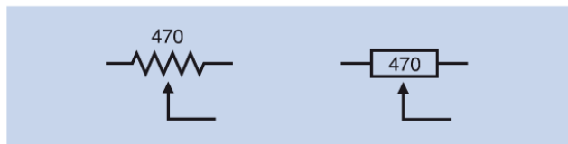
Figure 2-45. Le symbole de gauche représente un potentiomètre aux États-Unis, celui de droite est utilisé en Europe.
