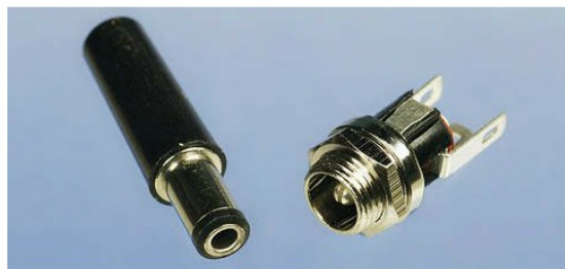
Figure 3-23. L'embase à droite peut être installée dans un coffret. Elle reçoit le connecteur mâle de gauche, qui sera relié à l'adaptateur d'alimentation.
