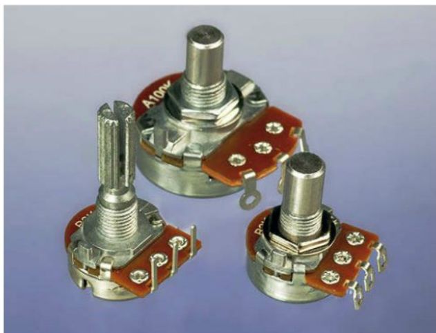
Figure 1-11. Potentiomètres ordinaires nécessaires pour les premières expériences.
