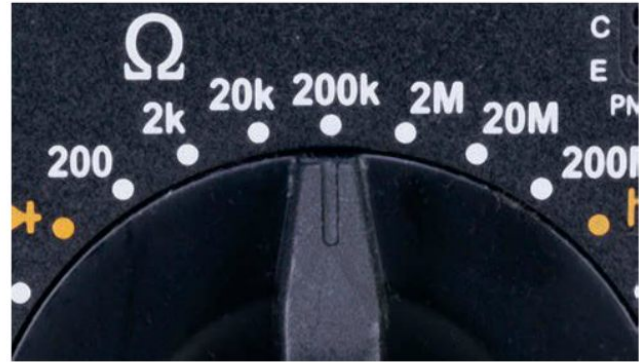
Figure 1-23. Un multimètre manuel nécessite que vous choisissiez la gamme de mesure.
