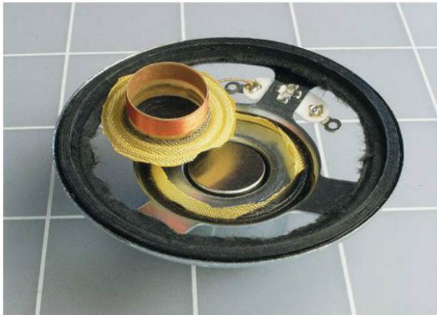
Figure 5-28. La bobine de cuivre est normalement dissimulée dans l'entrefer de l'aimant situé en dessous.
