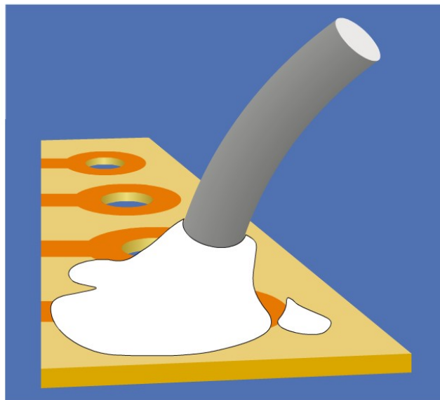
Figure 4-52. Si vous déposez trop de soudure, elle aura tendance à se déposer là où vous ne le voulez pas.
