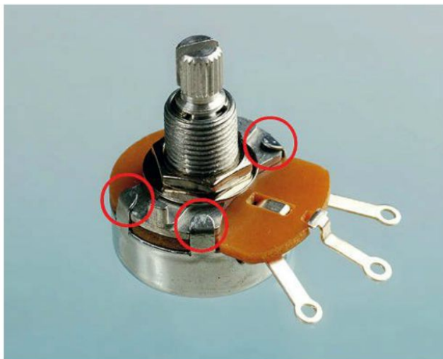
Figure 1-48. Languettes maintenant le potentiomètre assemblé.
