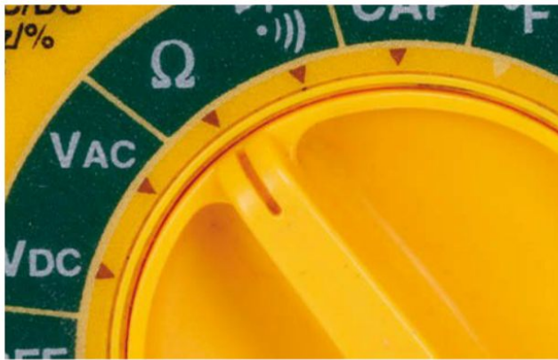
Figure 1-22. Sur un multimètre à gamme automatique, tournez simplement le bouton vers le symbole \Omega .
