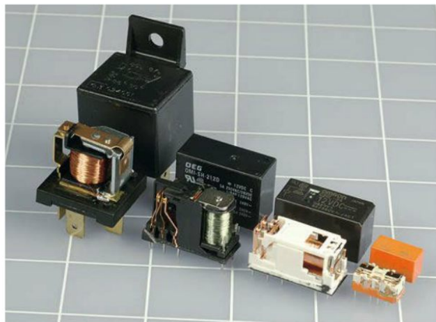
Figure 2-61. Quatre relais 12 V CC de différentes tailles avec leurs capots ouverts.
