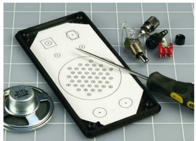
Figure 4-54. Un plan de positionnement des interrupteurs, LED et autres composants est collé sur la face interne du couvercle d'un coffret. Un poinçon est utilisé pour marquer les centres des trous à percer.
