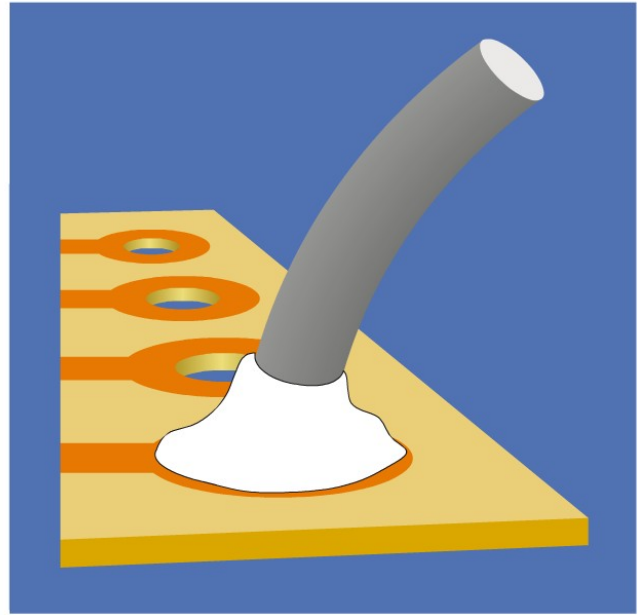
Figure 4-48. Votre soudure devrait ressembler à celle-ci.
