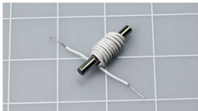
Figure 5-17. En déplaçant l'aimant, la tension mesurée sera plus importante si l'on ajoute des spires.
