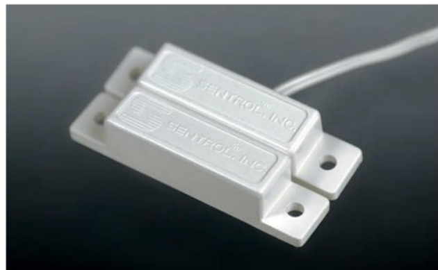
Figure 3-75. Capteur d'alarme constitué d'un aimant enfermé dans un boîtier plastique et d'un interrupteur magnétique « reed » logé dans un boîtier identique.
