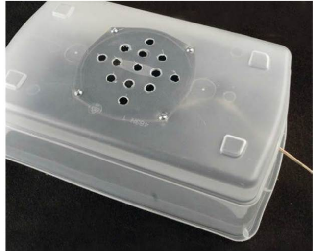
Figure 5-41. Une caisse de résonance est nécessaire si vous voulez entendre des basses de votre haut-parleur. Une boîte de rangement économique est suffisante pour cette démonstration.
