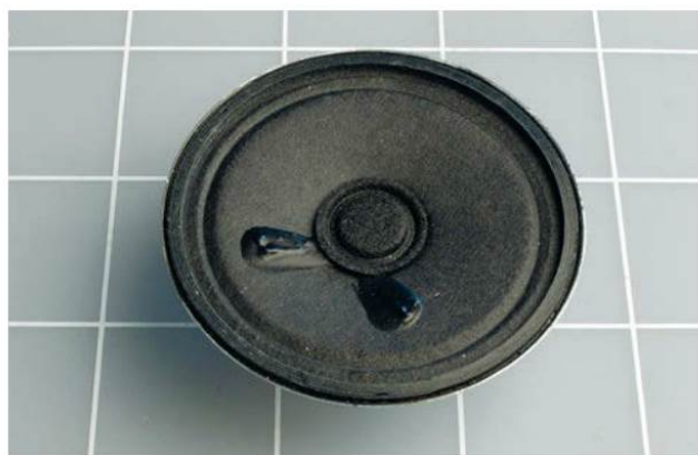
Figure 5-26. Petit haut-parleur de 5 cm prêt pour le démontage.
