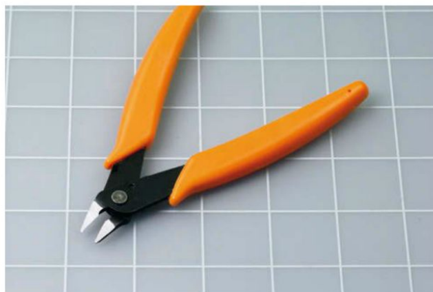
Figure 2-5. Les pinces coupantes de précision permettent de travailler dans des espaces plus restreints que les pinces coupantes traditionnelles.
