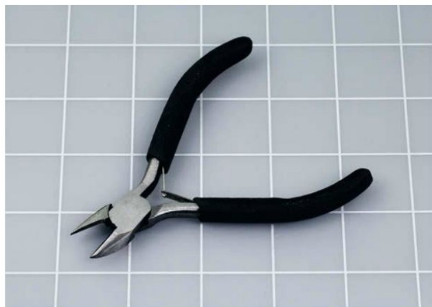
Figure 2-4. Les pinces coupantes ne doivent pas dépasser 13 cm de long.
