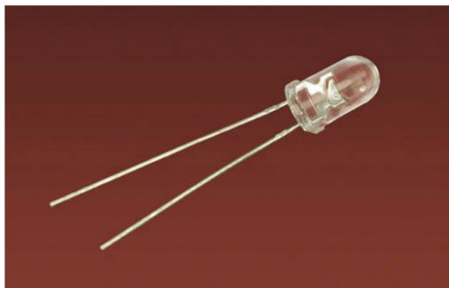
Figure 1-14. Diode (LED) de diamètre 5 mm.
