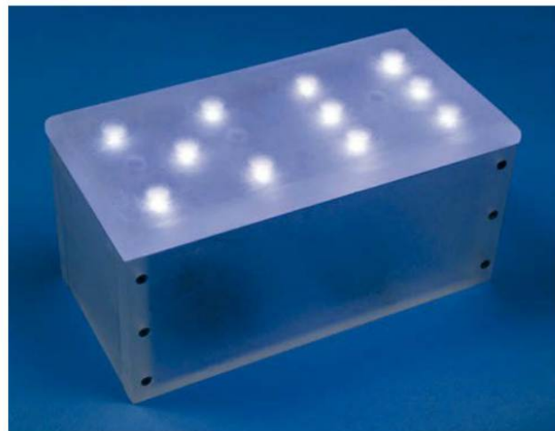
Figure 4-155. Ce module d'affichage des combinaisons de deux dés utilise des LED de 10 mm, intégrées dans un coffret en polycarbonate givré.
