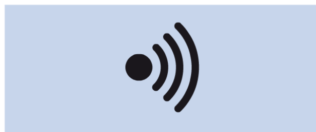
Figure 1-7. Ce symbole indique la fonction de test de continuité de circuit, avec retour sonore. C'est une fonction très pratique.
