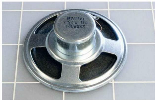
Figure 5-25. Vue arrière d'un petit haut-parleur.
