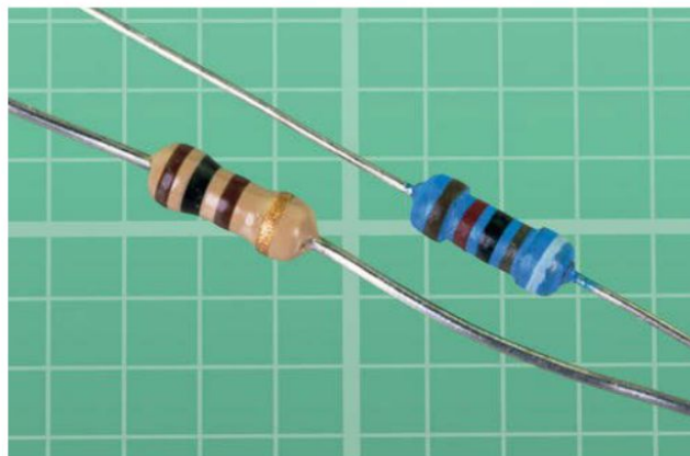
Figure 1-15. Deux résistances de \frac{1}{4} W correspondant au type dont vous aurez besoin.
