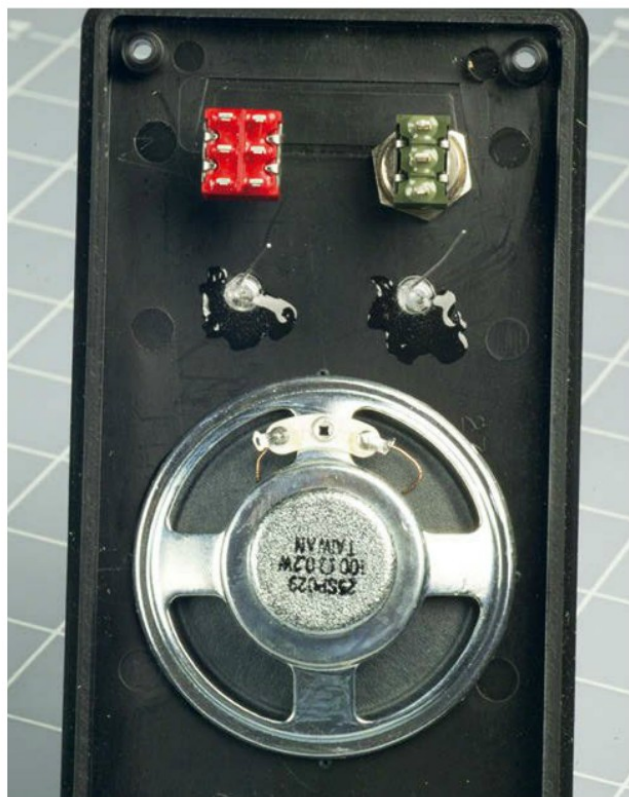
Figure 4-56. Les composants ont été ajoutés au panneau de contrôle du coffret (vu de l'intérieur). Le haut-parleur a été collé et le reste de la colle répandu autour des LED.
