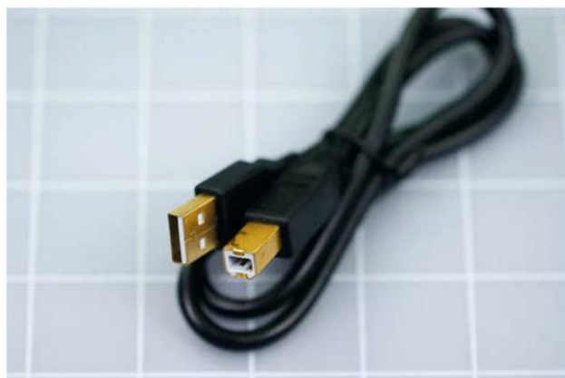
Figure 5-81. Vous aurez besoin de ce type de câble USB pour relier votre carte Arduino Uno à votre ordinateur.
